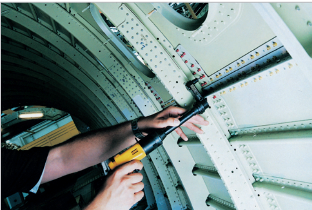
Die komplexen Bohreinheiten von LÜBBERING sorgen für eine sichere Anbringung von Flugzeugflügeln an den Rumpf
