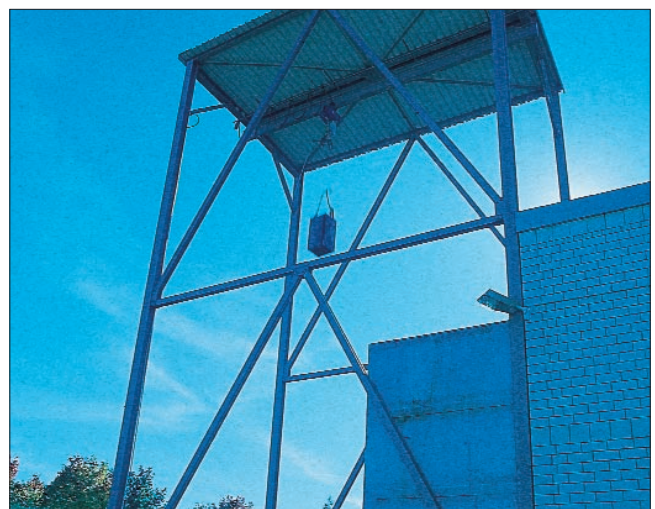
Der Sturztest: Nach der Feuerprobe müssen die Datenträger in den erhitzten Tresoren einen Sturz aus über neun Metern überstehen, ohne dass sich dabei der Innenraum verformt.
