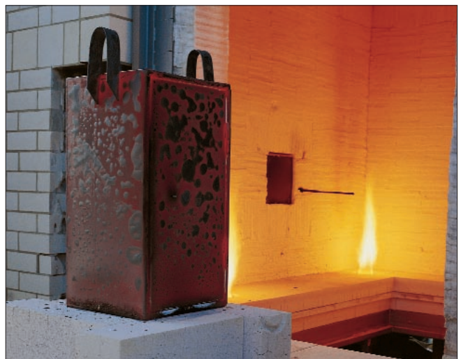
Die Feuerprobe: Die in Vorserienmodelle umgesetzten Ideen kommen ins hauseigene Testlabor. Tresore, die neben dem Einbruch auch Feuerschutz bieten, werden nach festgelegten Prüfnormen auf über 1000°C erhitzt, wobei die Innentemperatur bestimmte Werte nicht überschreiten darf.
