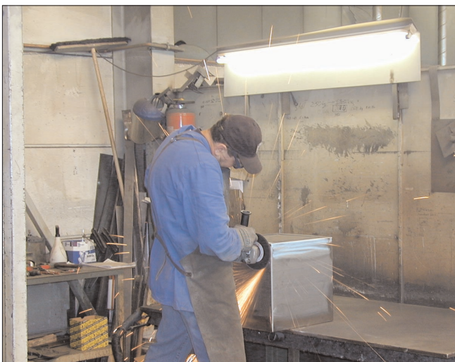
Montage: Die format-Tresore bestehen aus 40 bis 350 Einzelteilen. In der Montagehalle wird der Korpus zusammengeschweißt.
