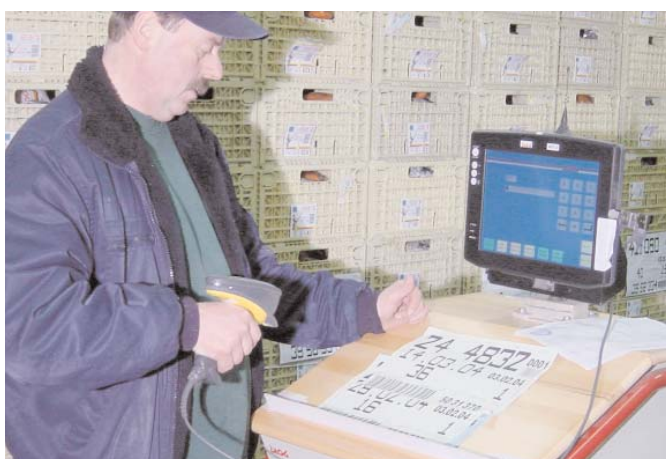
Terminal für Kommunikationsaufgaben in Fertigung, Qualitätssicherung und Logistik, das Anwender etwa bei Kommissioniertätigkeiten in der Lagerlogistik unterstützt
