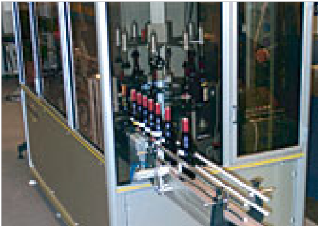
Durch die Lasermarkierung von Weinflaschen oder anderer hochwertiger Markenprodukte sind die Hersteller in der Lage, die Vertriebswege ihrer Produkte zu kontrollieren und Missbrauch vorzubeugen
